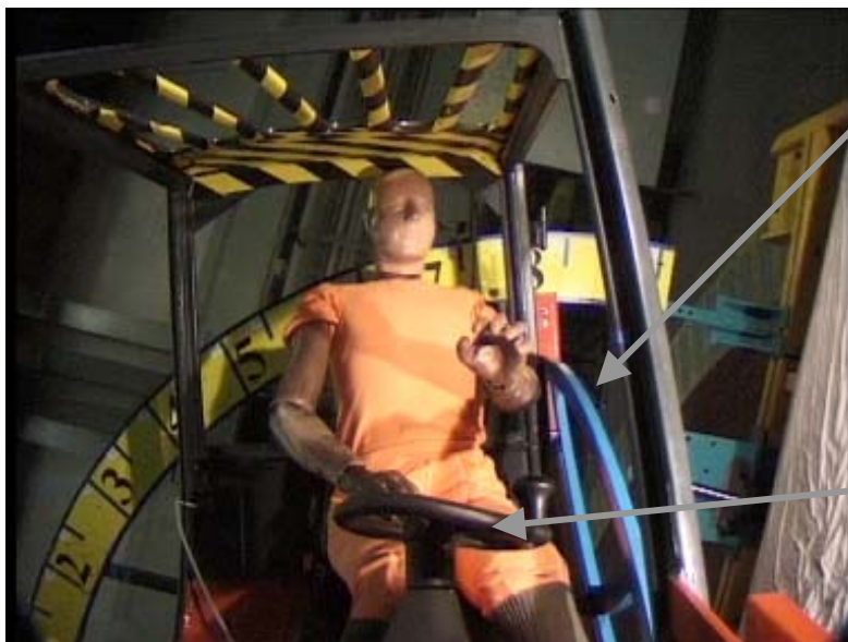
Afbeelding 8: dynamische kanteltest bij ca. 76°
