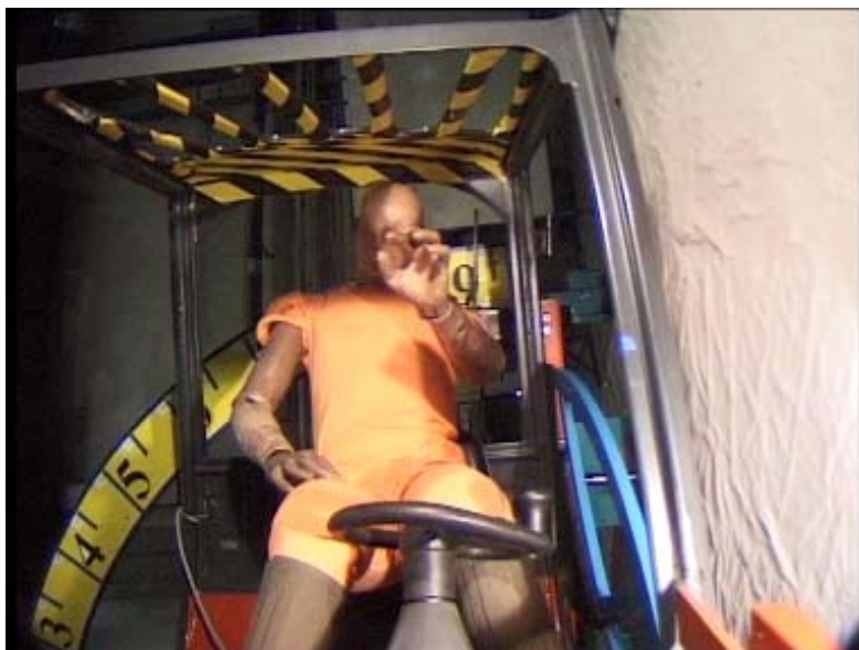
Afbeelding 9: dynamische kantelpoging - moment van neerkomen
