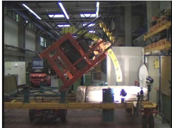
Afbeelding 6: dynamische kanteltest met een hoek van ca. 45°
