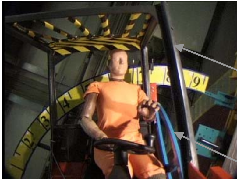
Afbeelding 7: dynamische kanteltest met meekantelende camera
