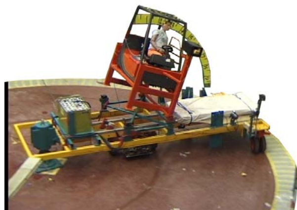
Afbeelding 2: kanteltest met een dummy
